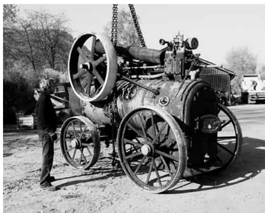
2 Skládání lokomobily, Mladějov, 2005. / Assembly of a portable steam engine, Mladějov, 2005.
